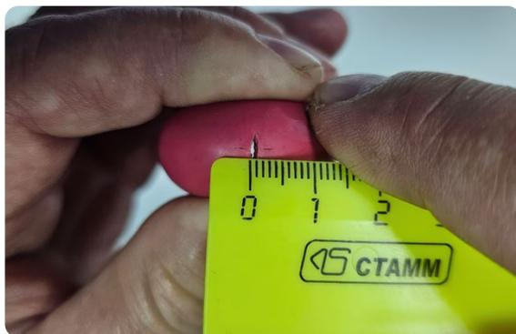
Рис. 1. Определить точный размер отверстия в сосках с крестообразным или щелевым отверстием сложно, а диаметр просто невозможно
