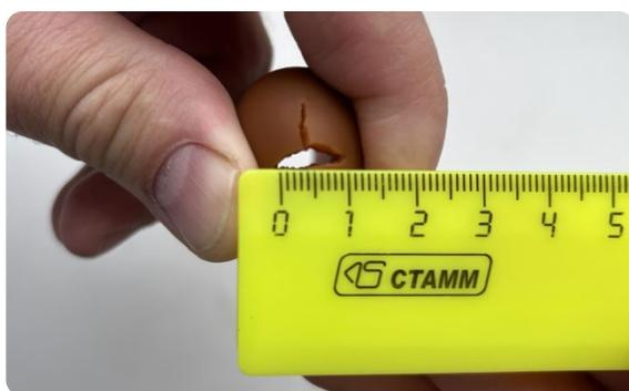
Рис. 2. Даже сильно порванные соски из жесткого материала с крестообразным отверстием не протекают. Но при этом позволяют теленку пить молоко слишком быстро
