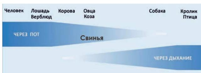
Рис. 5. Выделение водяного пара для охлаждения
