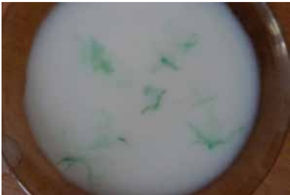
Рис. 2. При нарушении целостности молочного фильтра остатки физической пленки могут попасть в молоко
