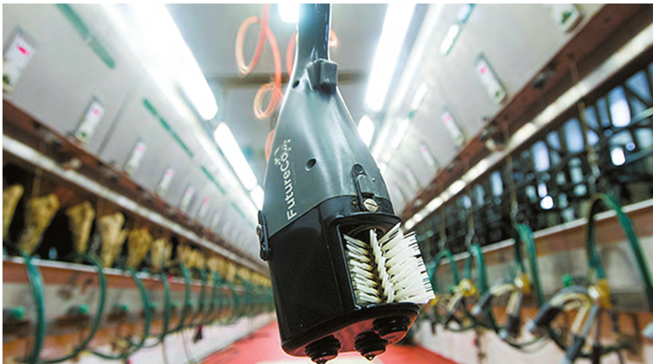
Рис. 2. Щетка для механической очистки и дезинфекции сосков перед доением
