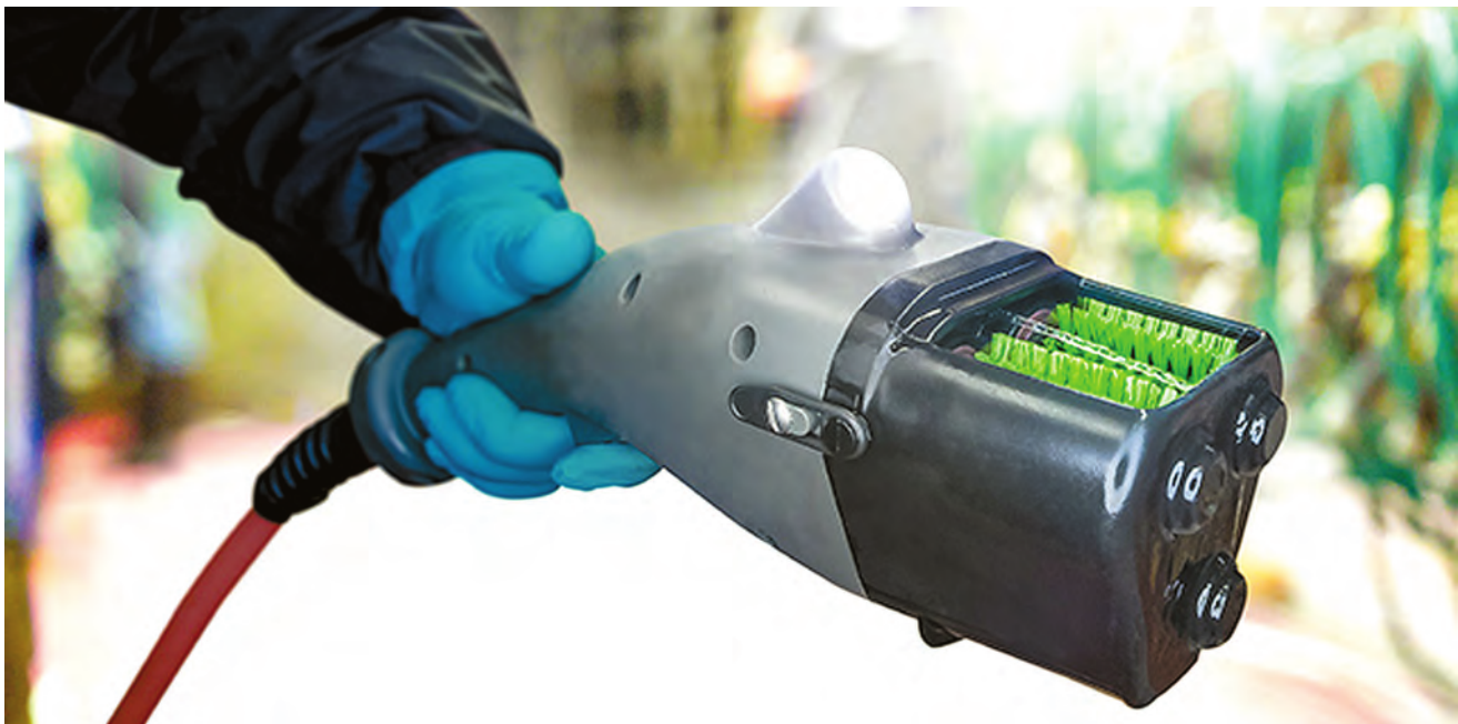
Рис. 4. Дезинфектант подается на щетину в процессе очистки сосков
