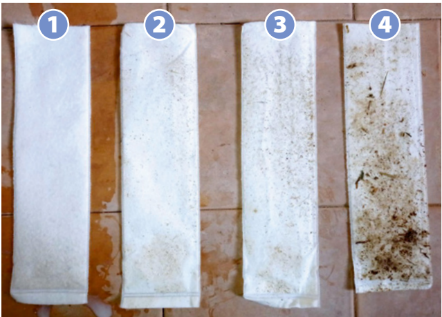
Рис. 9. Загрязненность фильтрующего элемента, 1–4-я группы
