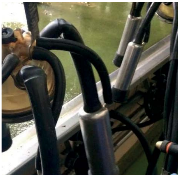
Рис. 6. Перекрученные короткие вакуумные трубки на подвесной части
