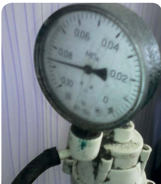
Рис. 2. Уровень вакуума фактически вдвое превышает нормативные значения для доильной установки
