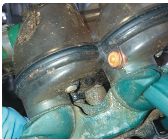
Рис. 9. В процессе доения и промывки через отверстие жиклера микроорганизмы попадают в доильное оборудование
