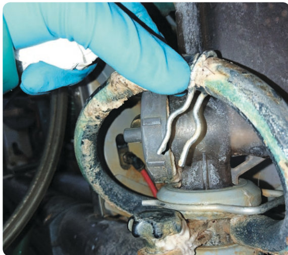
Рис. 10. Молокопровод и счетчики бывают самыми загрязненными местами доильного оборудования
