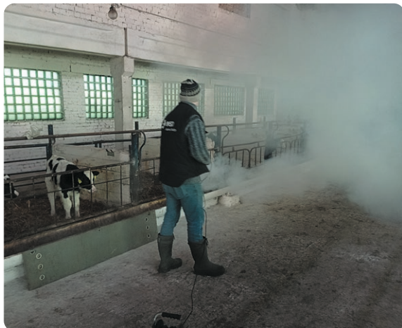
Рис. 3. «Задымление» – один из способов контроля качества вентиляции в помещении
